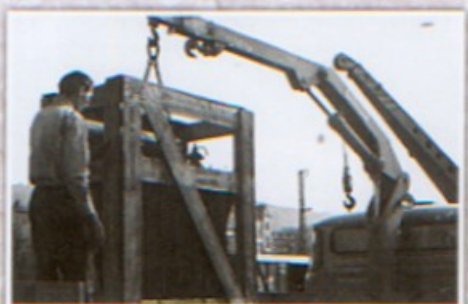
Dem für 1250 Kilopont ausgelegten Ladekran des W 50 verlangte das Umladen oft alles ab. Waren die Güter zu schwer, kam der Autokran
